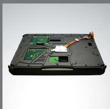
Unità di espansione PCI/PCI-Express 3.0
