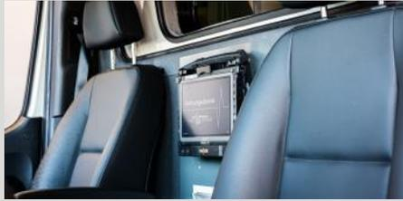
Das UX10-IP Tablet im Rettungsfahrzeug fest angebracht an der Havis-Fahrzeugdock.
